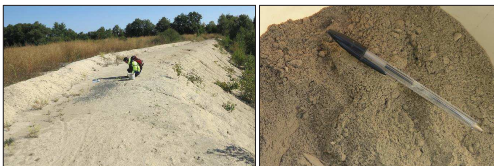
Figure 83 – Prélèvement de résidus sur la « digue » n°2 et vue du matériau prélevé pour analyses chimiques et granulométriques.
