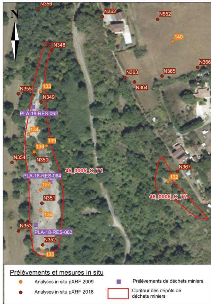
Figure 98 – Contour des dépôts de déblais de creusement du secteur de Combecave et localisation des points de prélèvements et mesures pXRF réalisés sur ces dépôts
