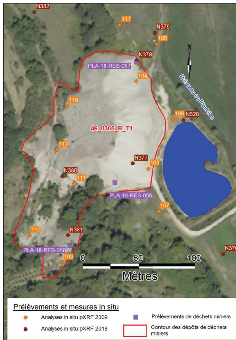
Figure 75 – Contour du dépôt de déblais de creusement de Fèges et localisation des points de prélèvements et mesures pXRF réalisés sur ce dépôt
