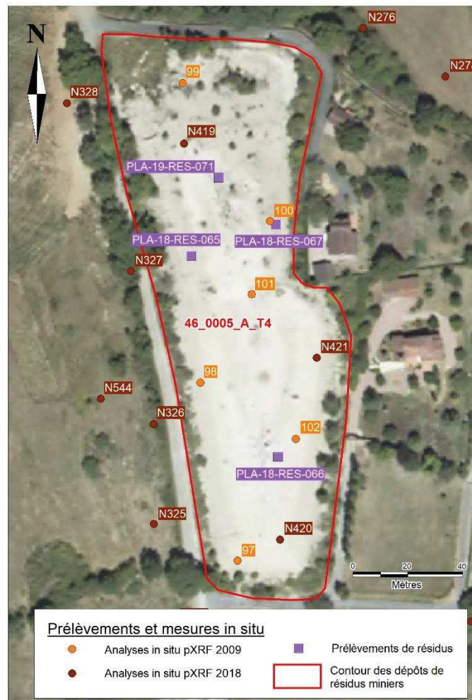
Figure 92 – Contour des dépôts de résidus de traitement du secteur des Justices (« digue » n°1) et localisation des points de prélèvements et mesures pXRF réalisés sur ces dépôts
