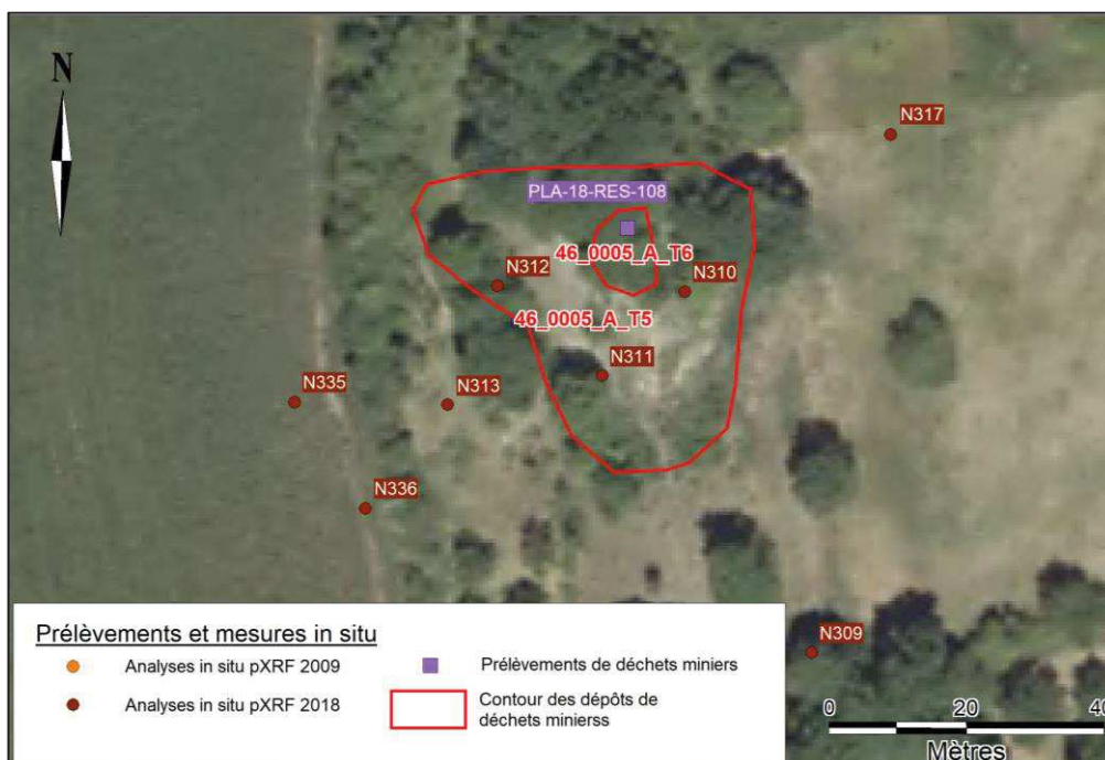
Figure 100 – Contour des dépôts de stériles de creusement du secteur de Combecave et localisation des points de prélèvements et mesures pXRF réalisés sur ces dépôts
