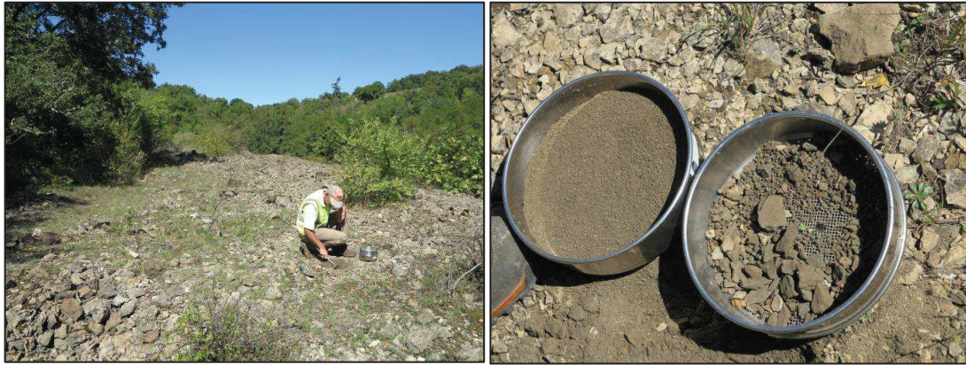
Figure 99 – Vue du sommet de la halde de Combecave, et des résidus avant et après tamisage à 2 mm
