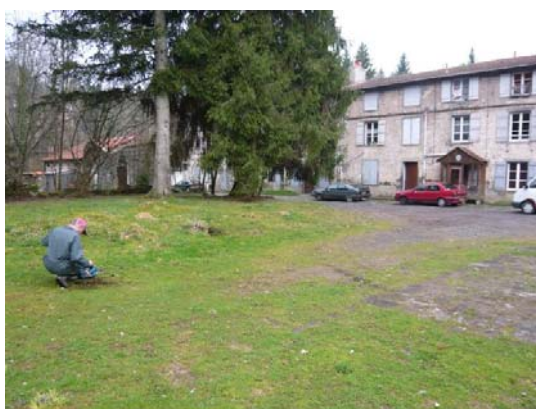
Point de mesure STD33 fortement pollué dans cours d'habitation (7 % Pb et 1 200 ppm As dans faciès gris noir)
