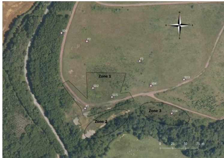
Illustration 108 : Buxières Terril Saint-Martin - Zones inspectées lors du contrôle thermique de terrain.
