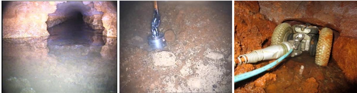
Illustration 25 : Émergence minière de la Fendue Lyon à La-Ricamarie (42) - Inspection du Puits de la Fendue Lyon par caméra-vidéo (à gauche et au centre) et avec robot (à droite).
