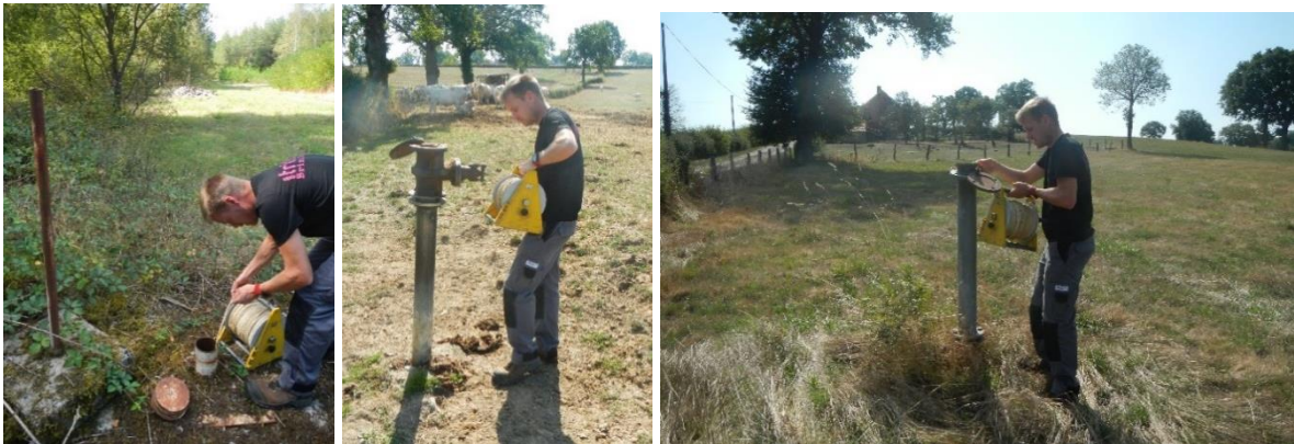
Illustration 104 : Buxières - photographies 2018 des piézomètres (de gauche à droite : Saint Hilaire, Sainte-Marie et Saint Charles).
