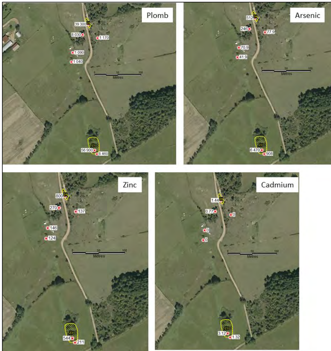
Figure 98 : Site de Nollieux - Teneurs en plomb, arsenic, zinc et cadmium dans les prélèvements de sols et résidus (les dépôts correspondent aux zones hachurées en jaune)
