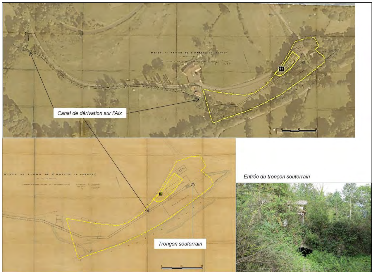
Figure 63 : Site de Grézolles - Canal de dérivation de l'ancienne laverie
