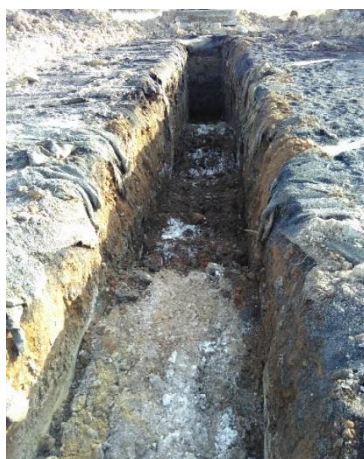
Illustration 77 : Montredon - exemple de tranchée d'investigation dans les résidus de traitement - Salsigne (11).
