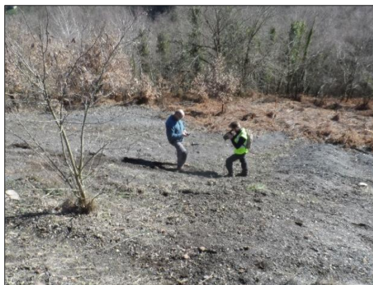
Illustration 103 : Terrils de l'Aérien et de Lacaze à Decazeville - Mesures par la sonde thermocouple (à gauche) et inspection par caméra thermique (à droite) en janvier 2018.
