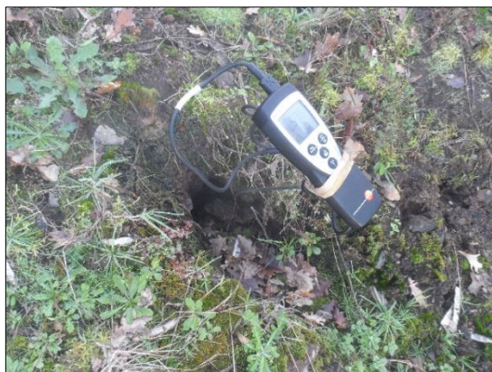
Illustration 103 : Terrils de l'Aérien et de Lacaze à Decazeville - Mesures par la sonde thermocouple (à gauche) et inspection par caméra thermique (à droite) en janvier 2018.
