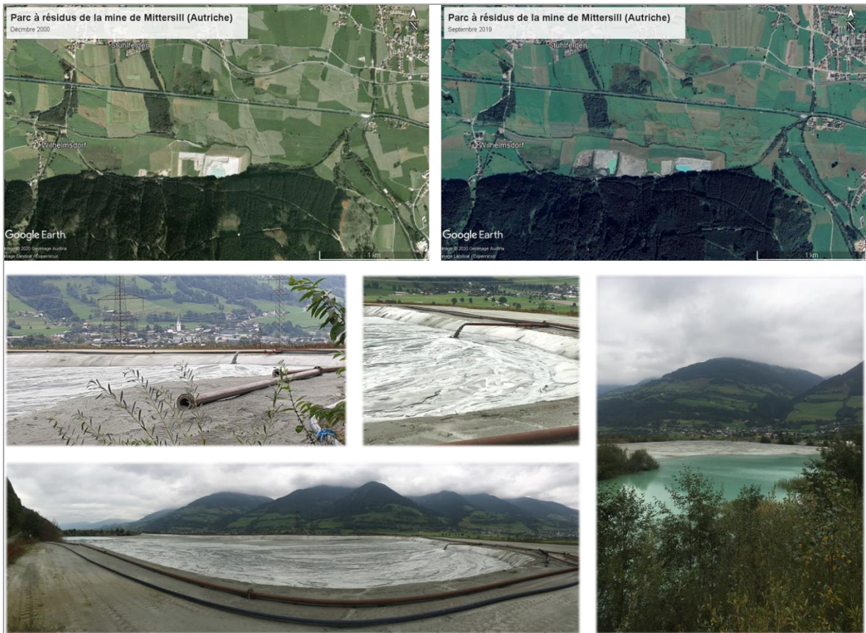
Figure 23 : (en haut) Vues satellitaires des parcs à résidus de la mine de Mittersill (en 2000 et en 2019) (© Google) ; (en bas) Vues détaillées des parcs en cours de remplissage en 2019 (Association Stop Mines 81)
